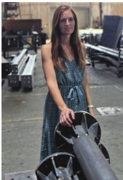
Annabelle Haas in der Werkstatt vor fertigen Masten mit angeschweißten Flanschen und Knotenblechen.
