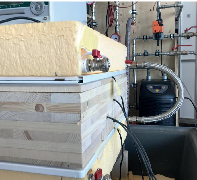
Beim Forschungsprojekt aHolz wurden Rohrleitungen in Massivholzelemente eingefräst und mit einer Holzdeckschicht verleimt. Aktuell läuft das Folgeprojekt Activation.Wood zu Umsetzungspotenzialen.
