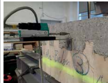
Messung der Schubverformung zwischen Holz und Beton am Deckenelement von Longin.
