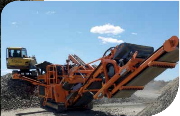
Rockster arbeitet u.a. mit einem integrierten Windsichter, der durch ein variabel regulierbares Gebläse unerwünschte Leichtstoffe wie zB Styropor, Plastik, Textilien, Gips, Folien oder Holz entfernt, ergänzt durch das Siebssystem.
