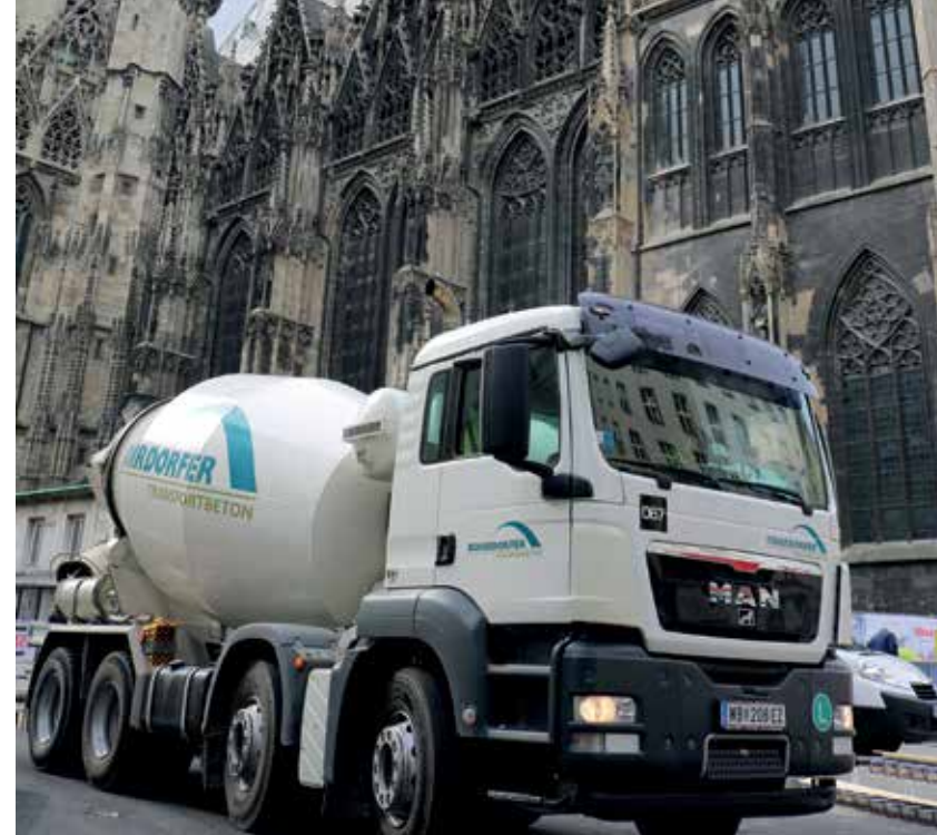
Für die Fahrt im Fahrmischer und die folgende Verarbeitung müssen die Betone vorbereitet werden.
