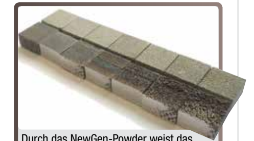
Durch das NewGen-Powder weist das verflüssigte Metall im Schmelzbad eine höhere Stabilität auf.
