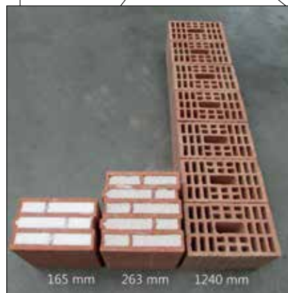
Aerobrick ist ein mit Aerogelgranulat befüllter Dämmziegel. Die Wärmeleitfähigkeit wird um 35 Prozent verbessert.
