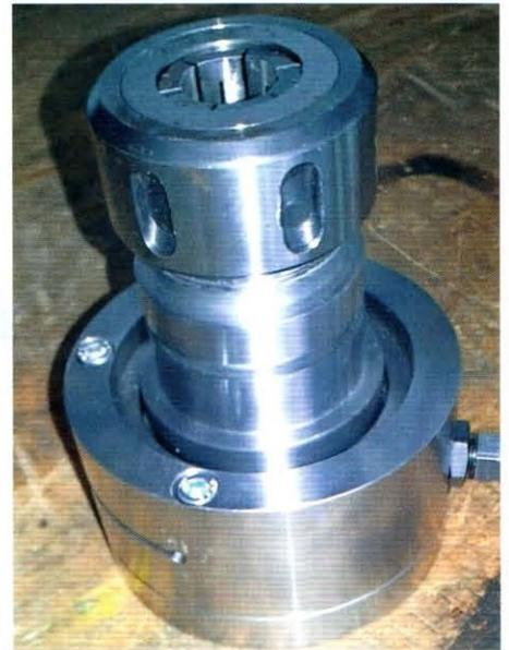
Zum Lehrabschluss fertigte Stefanie Huber einen Teileapparat, eingebunden in eine CNC-Steuerung, um bei einem Werkstück Kanten zu fräsen.
