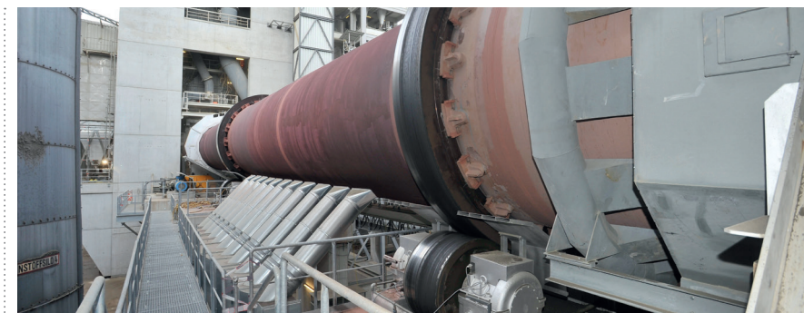
Innovatives Beispiel in der Zementproduktion ist die Errichtung eines Thermoölnetzes zur Brennstoffvorwärmung. Damit kann eine jährliche Einsparung an fossilen Energieträgern von 200.000 m 3 Erdgas erzielt werden (Wärmetauscher und Drehrohrofen Zementwerk Leube).
